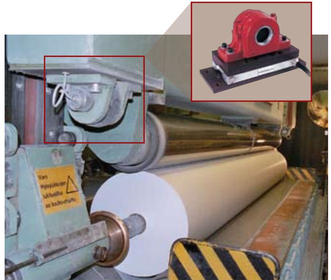
传感器安装于压纸辊上
