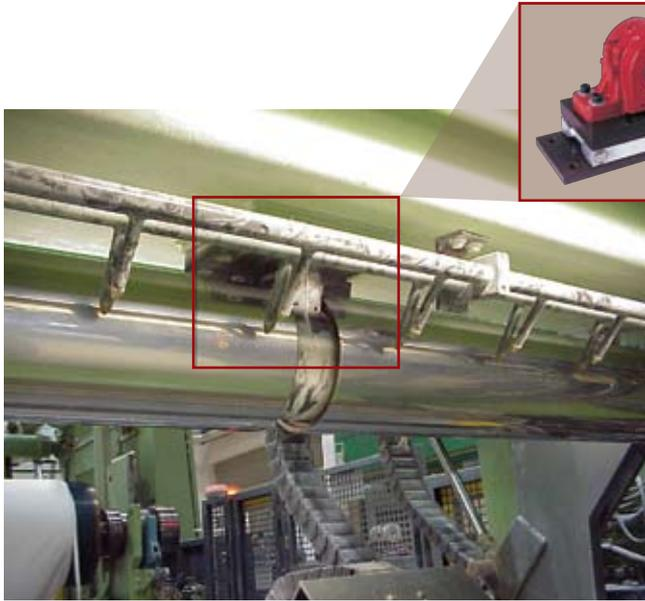
传感器安装在轴承托架
